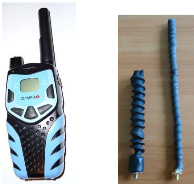
Rys.5. a. Radiotelefon PMR, b. modele próbne – gniazdo SMA, co pozwala podłączyć np. do Motoroli DP3601
