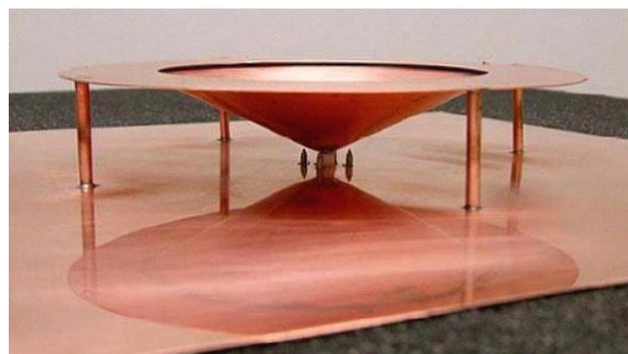
Rys.4. Szerokopasmowa antena na UAV (0.8-2.4 GHz) [4]
