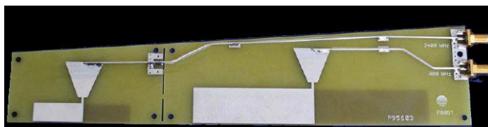
Rys.2. Anteny dipolowe do umieszczenia w skrzydle obiektu latającego [5]
