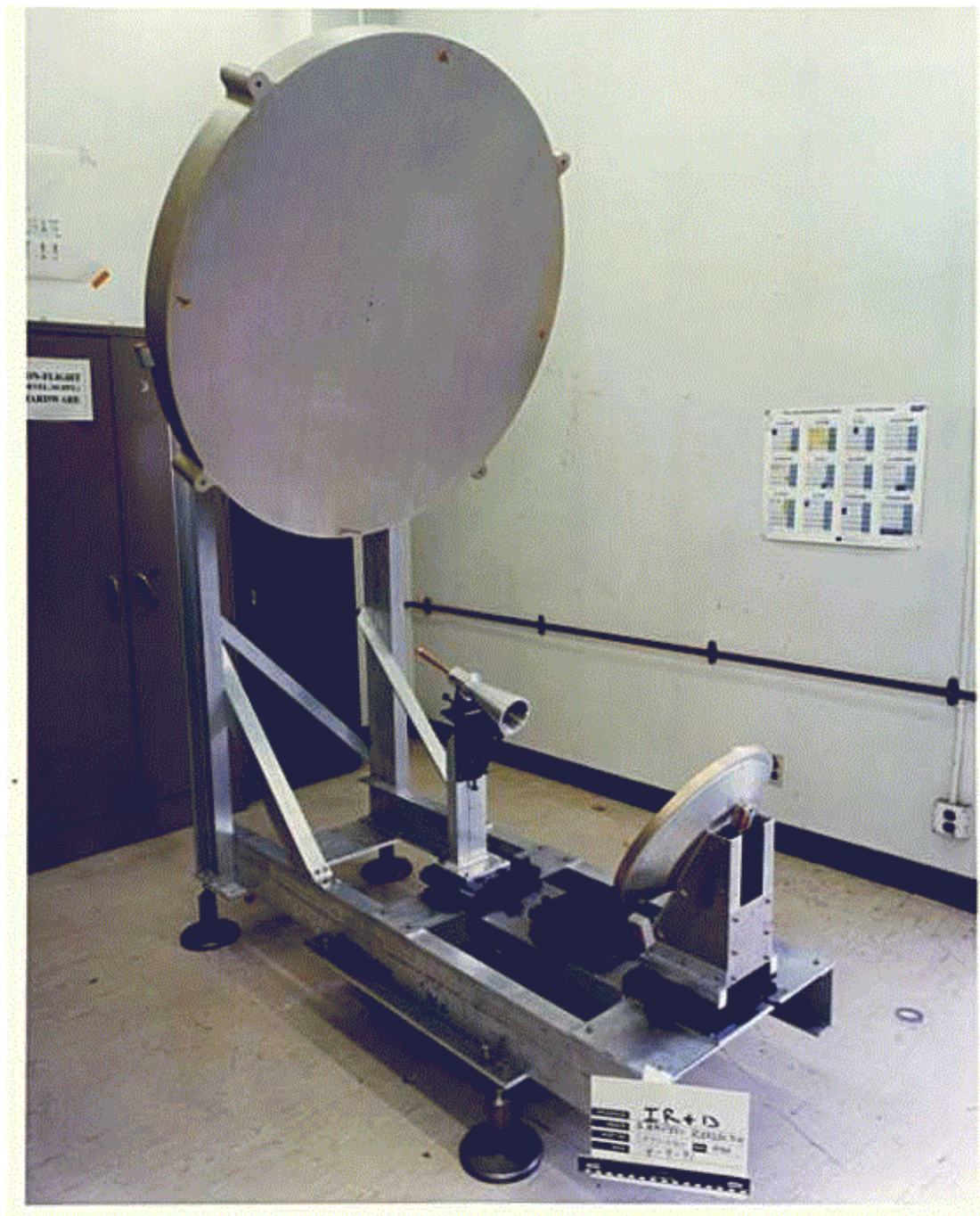
Rys.1.4 Niesymetryczna antena dwurefleksyjowa - model laboratoryjny (zdjęcie uzyskane ze strony internetowej firmy Hughes).
