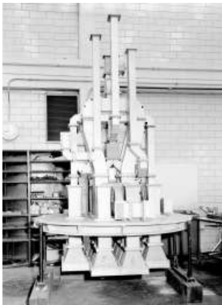
Rys.3. Układ formowania sygnału monoimpulsowego w antenie reflektorowej [ ]
